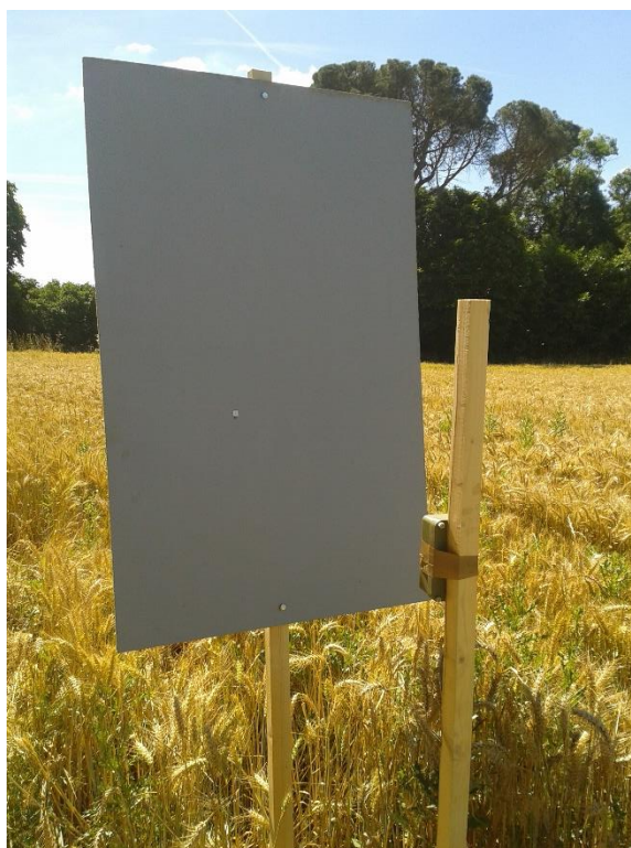
Figure 13 : Dispositif d'enregistrement vidéo des flux d'insectes en bordure de culture, la caméra BEECAM est située à 1m20 du sol et à 60cm du panneau. Source : A.Villeneuve.
